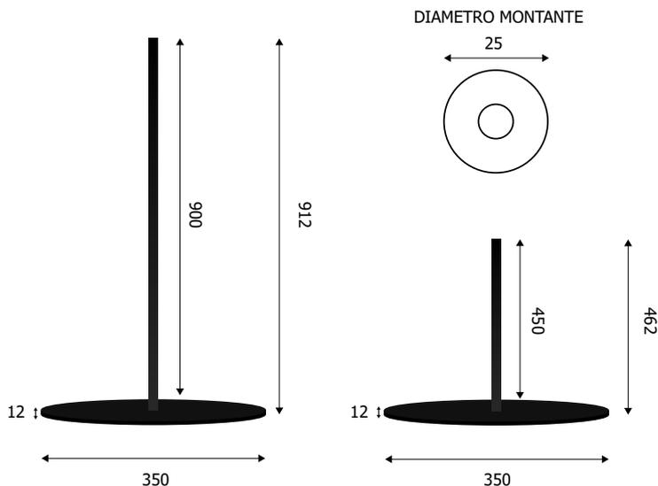
Colonnina linea MUSEUM finitura nero opaco con base piatta diametro 350 mm. Montanti altezza 450 o 900 mm, diametro 25 mm con foro passante per cordino e grano superiore di bloccaggio. Cordino elastico colore rosso o nero diametro 5 mm, lunghezza 5 o 25 metri.
